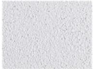
Die Kellergeschosswände erhalten einen Kalkzementputz (Leichtputz), außer Betonwände.
